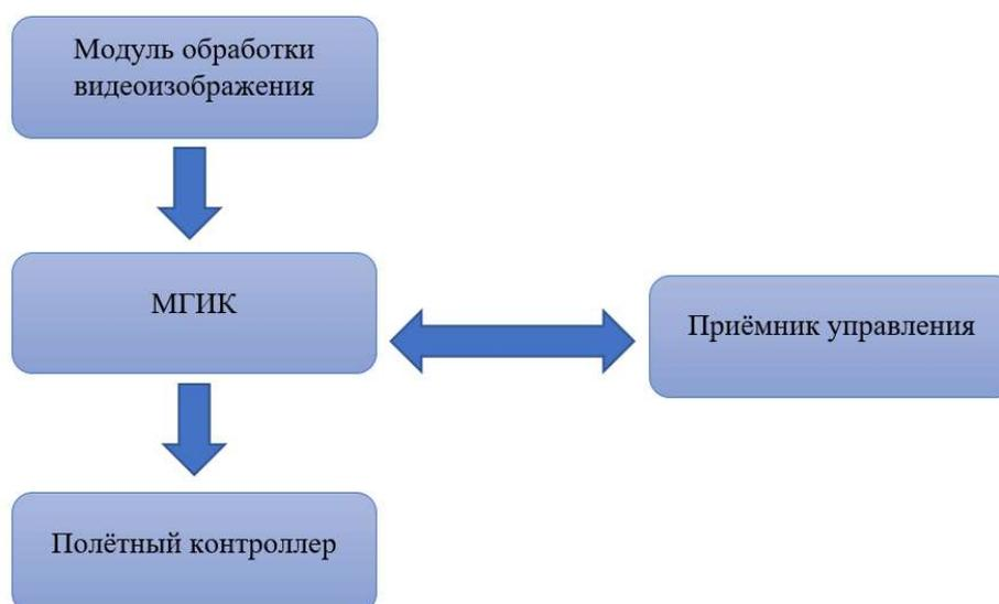
**Рис.1. Модуль генерации искусственных команд**
