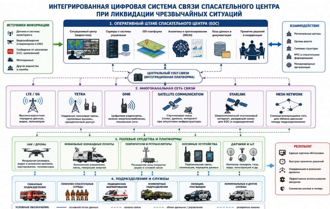
Рисунок 3. Интегрированная схема цифровой системы связи спасательного центра
