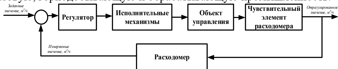
Рис.1. Автоматизированная система контроля и регулирования расхода жидкостей и газов, м³/ч.
