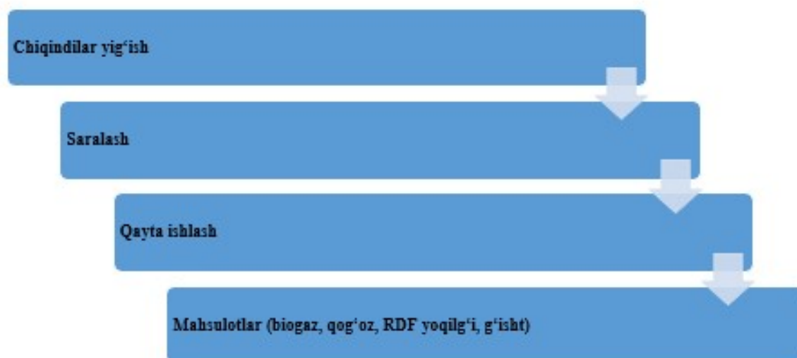
2-rasm. Urganch shahridagi chiqindilarni qayta ishlash zavodining ishlash tamoyili 65
